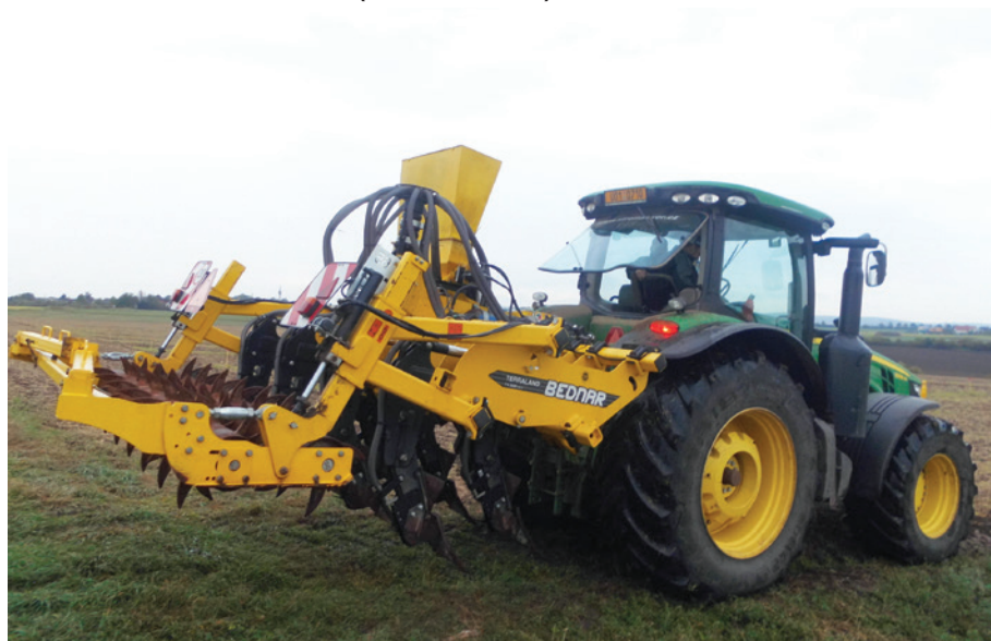
Obr. 1: Mechanizace – dlátový pluh s vývojovou verzí dávkovače melioračních hmot (BEDNAR FMT)
