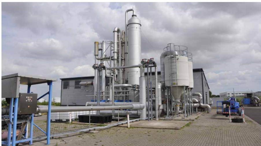
Technologie úpravy bioplynu na biometan s kapacitou 1750 m 3 /hod (Foto: Adam Moravec)
