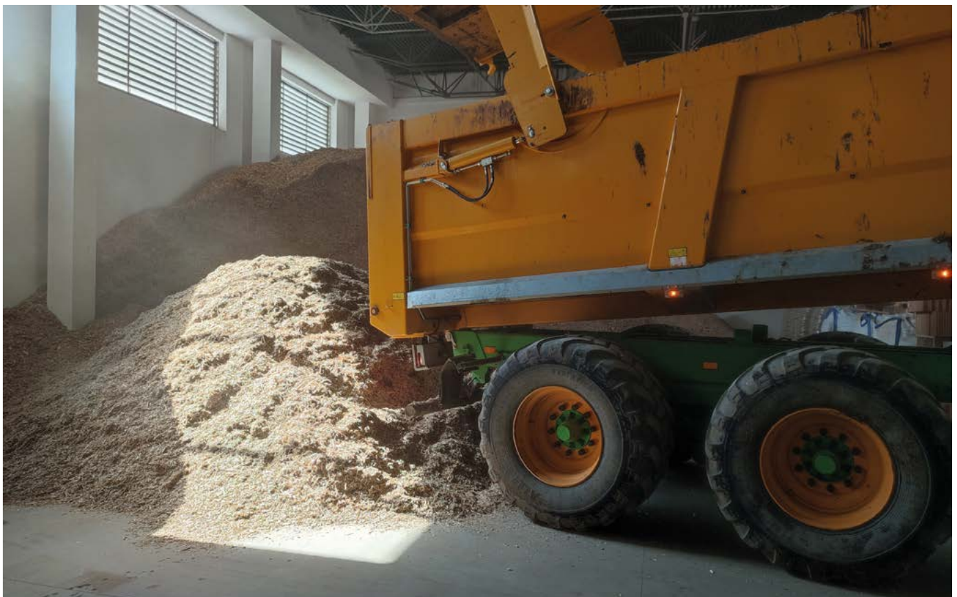
Obrázek 4: Sklad paliva. Řezanku z ozdobnice není nutné nijak dále upravovat (zdroj: Lukáš Sovák)
