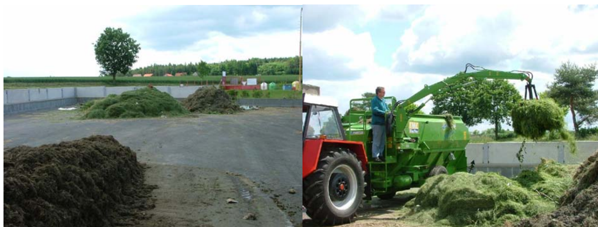
Obr. 5.14: Skládka EKOSO s.r.o. Trhový Štěpánov. Odpad z péče o zeleň, tráva a křoviny. Nakládka do upraveného krmného vozu - drtiče.
