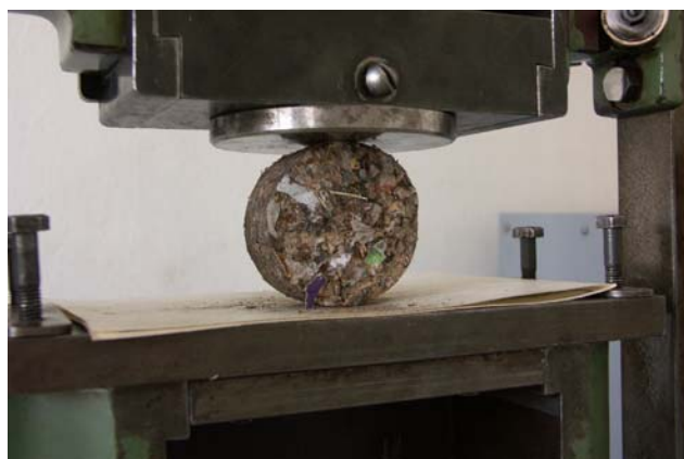
Obr. 5.3: Mechanická zkouška na porušení brikety
