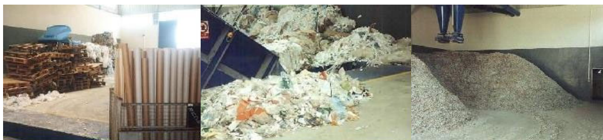
Obr.6.1: Technologie na výrobu TAP zpracovává odpady v přibližném složení plast 40%, papír 20%, dřevo 20%, pryž a textil 10%, zdroj ODES s.r.o. Jaroměř.
