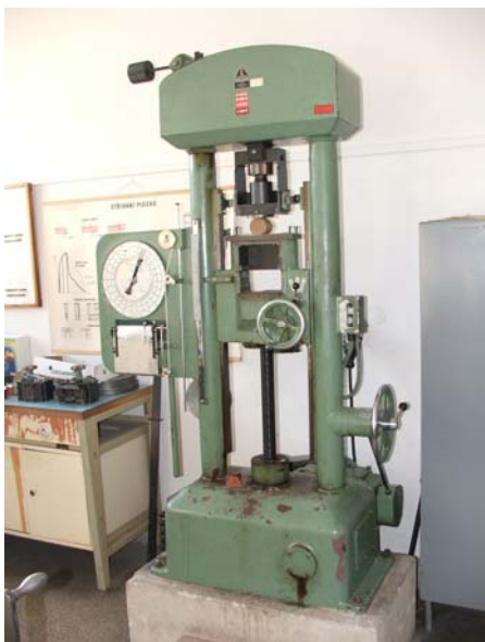
Obr. 5.8: Zkouška mechanických vlastností briket na univerzálním trhacím stroji ZDM-5
