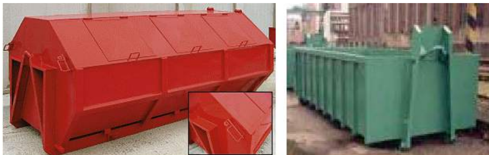
Obr. 4.1.: Velkoobjemové kontejnery pro sběr velkoobjemových odpadů, zejména stavebních odpadů a zeleně.
