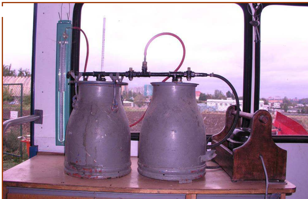
Obr. 5: Zjišťování pórovitosti surovin v měřicím voze
