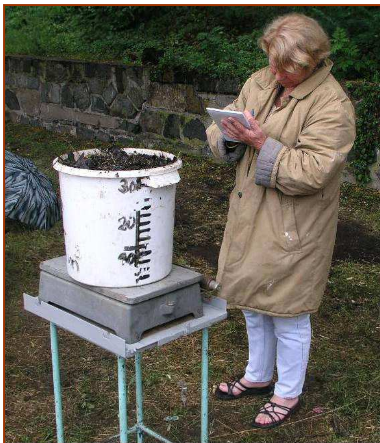
Obr. 2: Vážení odebraného vzorku pro stanovení objemové hmotnosti
