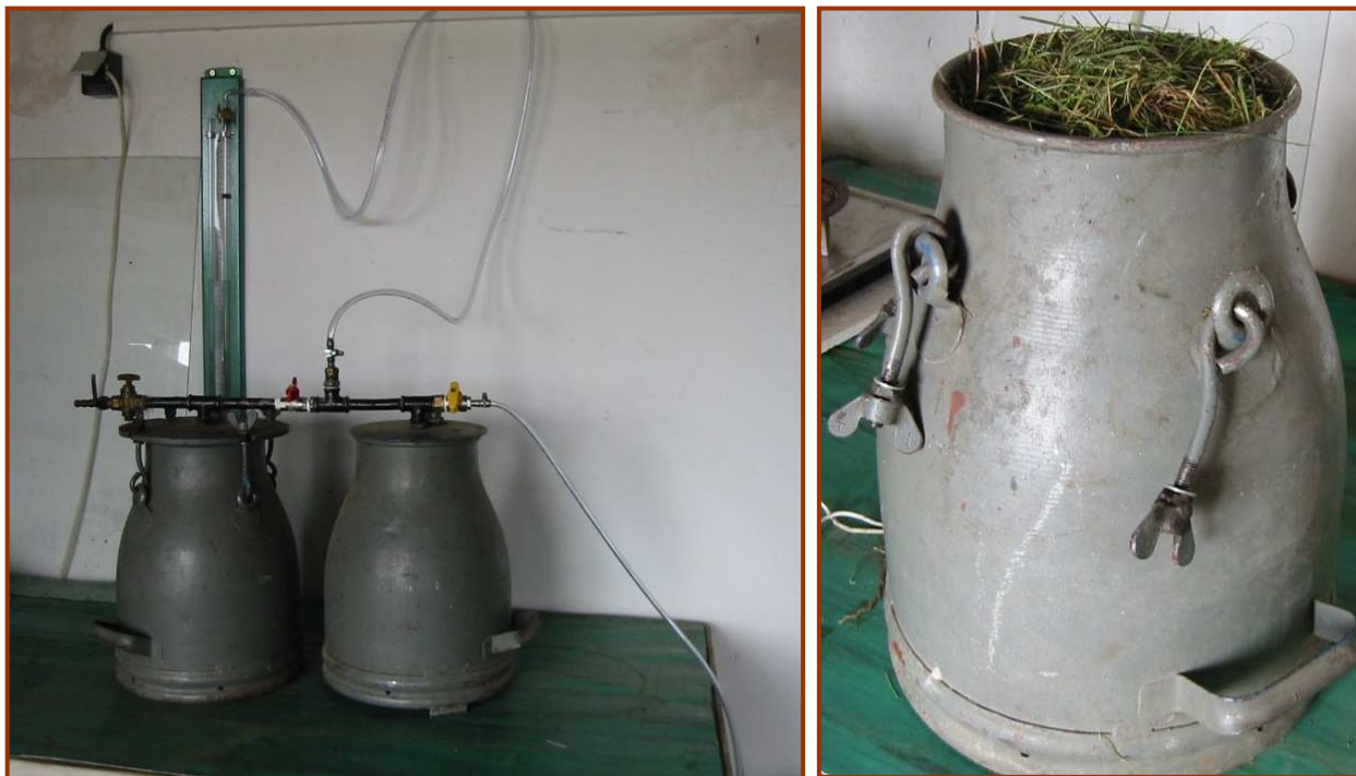
Obr. 4: Zjišťování pórovitosti surovin v laboratorních podmínkách
