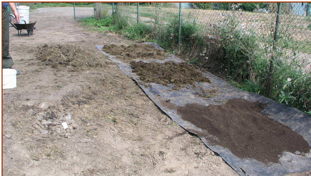
Obr. 1: Příprava vzorků pro stanovení objemové hmotnosti
