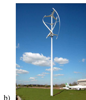
Obr. 2: a) Větrná turbína s vodorovnou osou rotace – Proven WT6000 (Zdroj: Proven Energy) b) Větrná turbína se svislou osou rotace - Quite Revolution 5 (Zdroj: XC02 Low Carbon Engineering)
