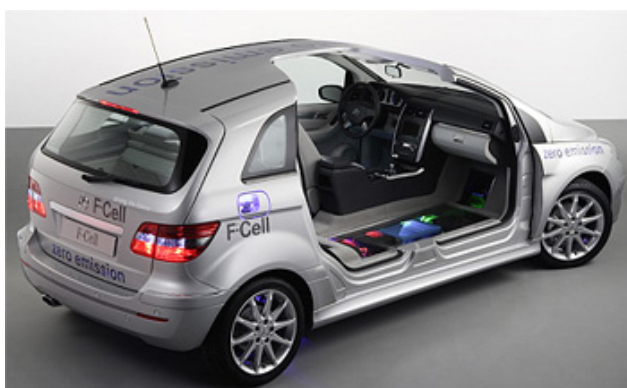
Obr. 3.59.: Automobil Mercedes F-Cell, třída B, detail na svazek palivových článků (Ballard PEM), výkon 100 kW, stlačený vodík (demoverze, Ženeva březen 2005)
