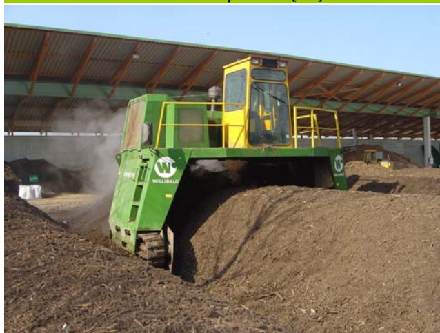
Obrázek 5.6: Kompostování na hromadě s překopávačem ve Švýcarsku [48]
