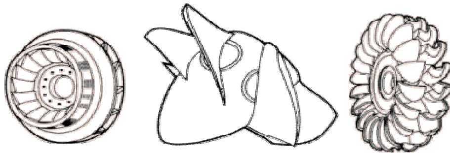
Obrázek 7 Základní typy turbín (zleva: Francisova, Kaplanova, Peltonova)
