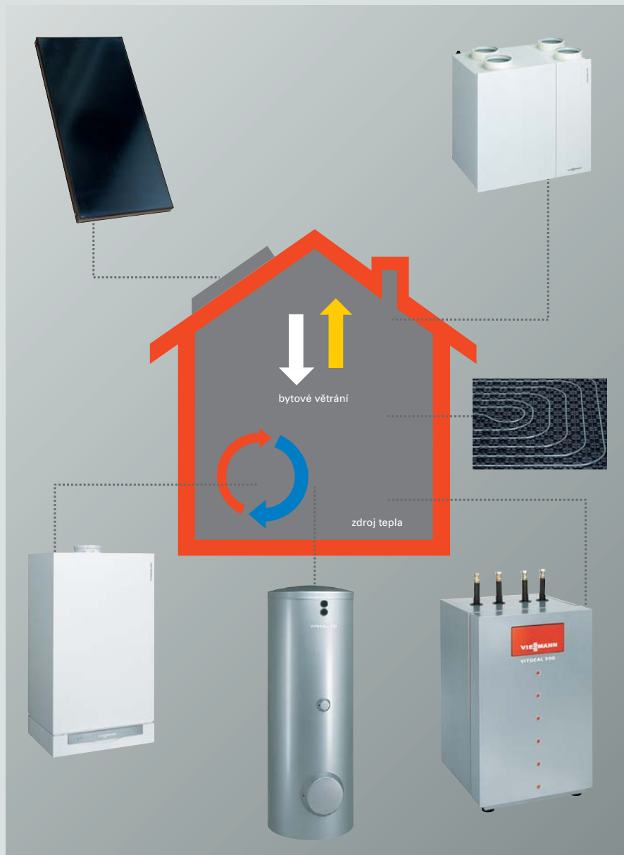
Obrázek 14: Systémová technika nízkoenergetického domu
