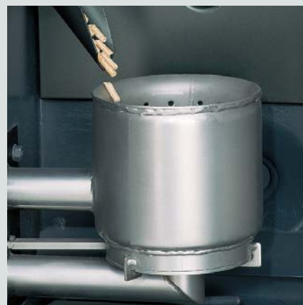
Obrázek 49: Miska hořáku z žáruvzdorné ušlechtilé oceli
