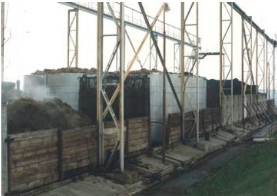
obrázek 23: Zásobníkový systém na zpracování slamnatého hnoje v Jindřichově. Foto Jiří Beranovský, EkoWATT.
