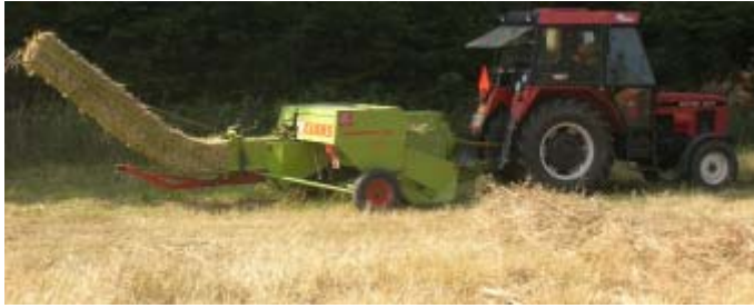
Obr.4.5.15.: Lisování chrastice rákosovité do malých hranolových balíků
