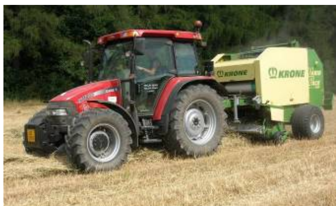
Obr.4.5.8.: Svinovací lis KRONE Vario Pack multi-cut 1500 v soupravě s traktorem CASE JX 1100 U.
