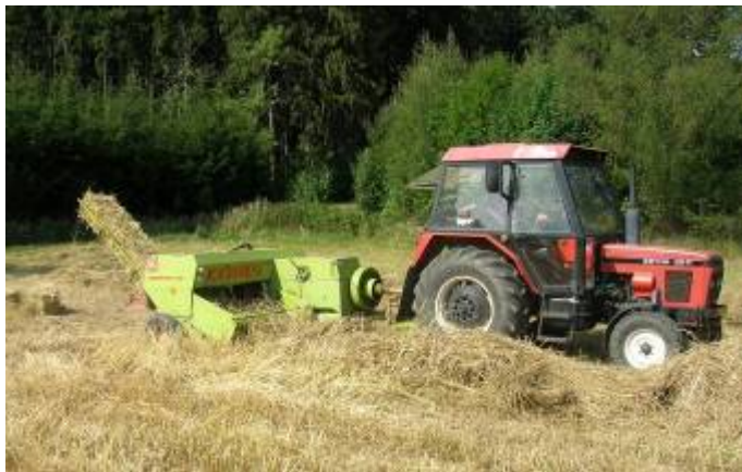
Obr.4.5.6.: Lisování chrastice rákosovité do malých hranolových balíků
