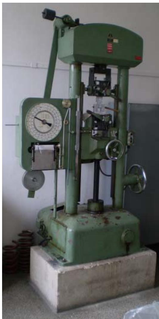
Obr. 4.2.4.: Mechanický trhací stroj používaný při měření
