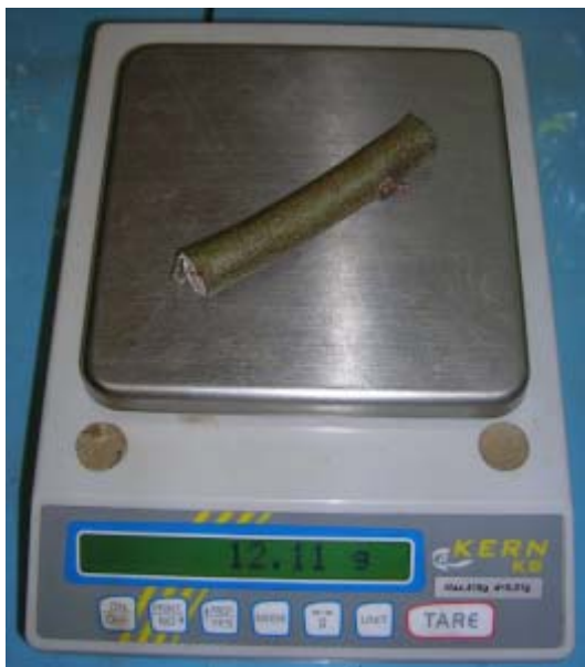
Obr. 4.2.3.: Stanovení hmotnosti etalonu na laboratorních vahách.
