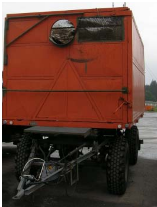
Obr. 4.1.3: Velkokapacitní přívěs používaný při sklizni a dopravě trávy
