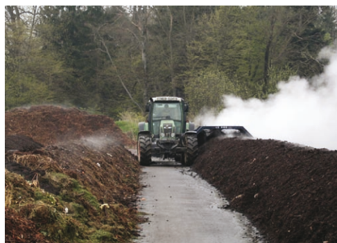
Obr. 2: Překopávání kompostu při použití technologie otevřených pásových hromad
