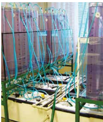
Foto 1: Laboratorní 48-hnízdní zařízení pro sledování vývoje bioplynu s automatickým časovaným promícháváním
