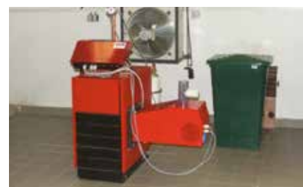
Spalovací zařízení s rotačním roštem (archiv VÚZT, v.v.i.)
