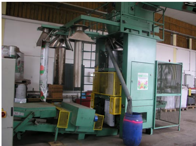
Obr. 47: Linka pro balení kompostu do pytlů (hadicový balicí automat)
