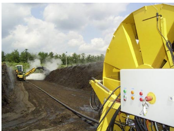
Obr. 39: Překopávač kompostu spojený závlahovým bubnem upravující vlhkost zakládky
