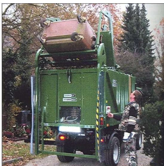
Obr. 11: Nástavba svozového automobilu se zadním podávacím zařízením
