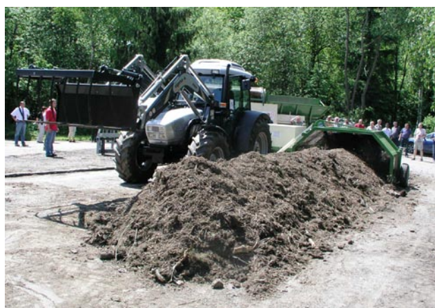
Obr. 35: Traktorový překopávač kompostu rotorový
