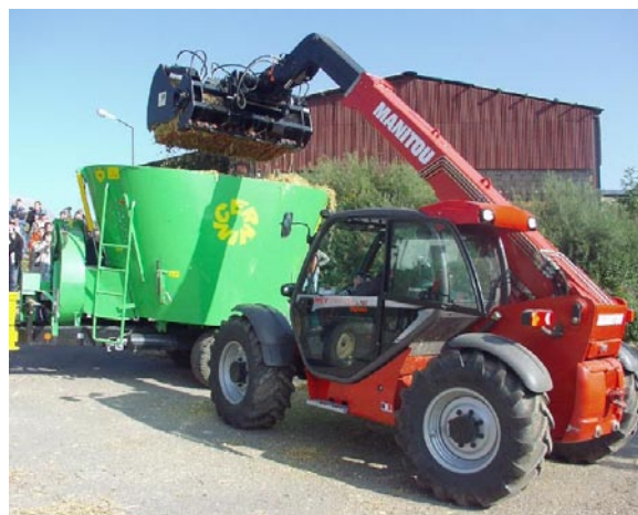
Obr. 34: Míchání kompostové zakládky pomocí mobilního zařízení
