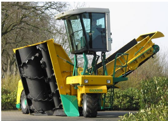
Obr. 38: Překopávač kompostu s bočním rotorovým pracovním ústrojím
