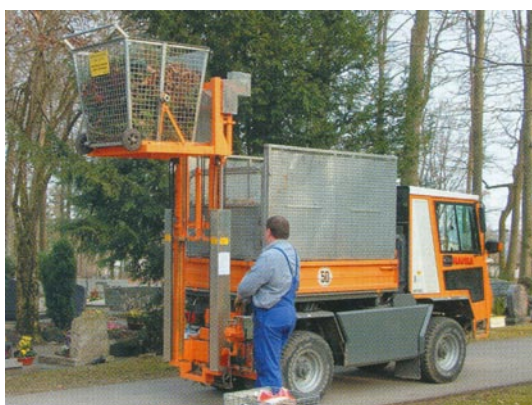
Obr. 8: Nástavba nákladního automobilu pro sběr BRO
