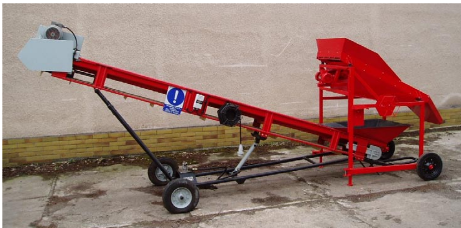
Obr. 42: Vibrační třídič s rovinným sítem VSD-01 s vynášecím dopravníkem
