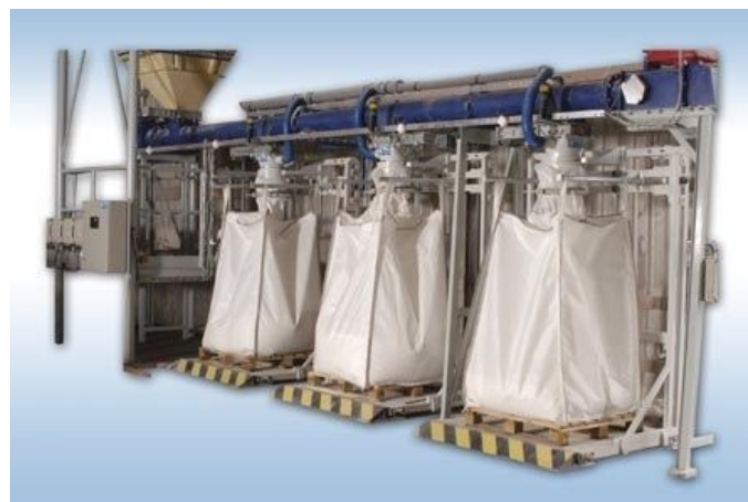
Obr. 48: Linka pro balení kompostu do velkoobjemových vaků
