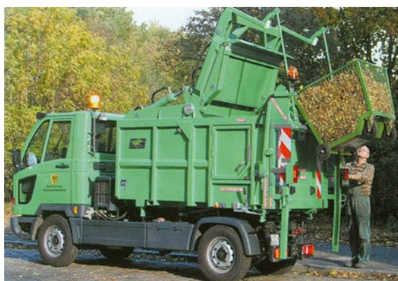
Obr. 9: Nástavba nákladního automobilu pro sběr BRO v klecových kontejnerech
