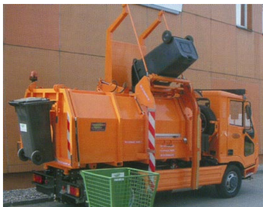
Obr. 7: Nástavba nákladního automobilu se zadním a bočním podávacím zařízením
