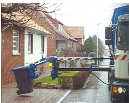
Obr. 10: Svozový nákladní automobil s hydraulickým manipulátorem
