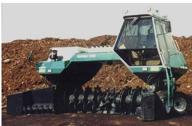
Obr. 36: Samojízdný překopávač kompostu rotorový
