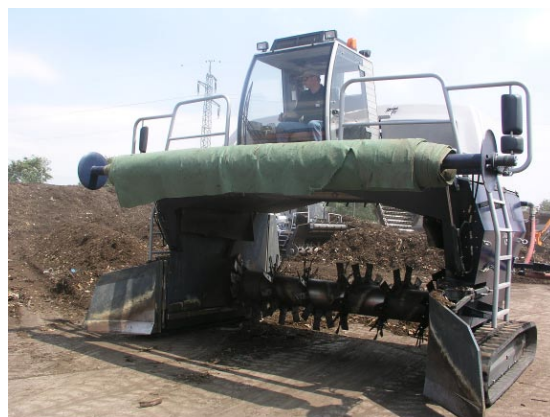
Obr. 40: Překopávač kompostu s adaptérem k navíjení kompostování plachty
