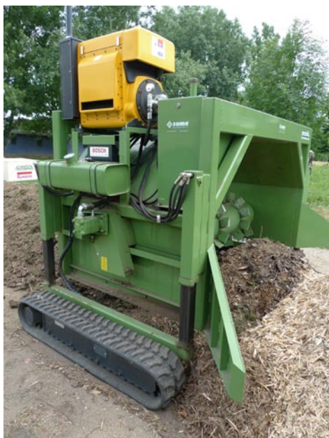
Obr. 37: Samojízdný překopávač kompostu o malém záběru
