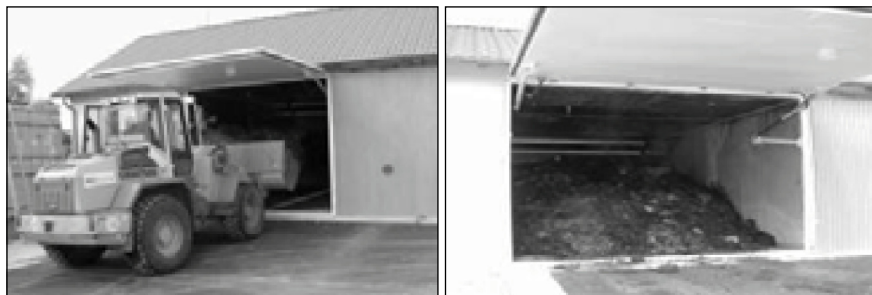
Obrázek 3–8: Boxový fermentor při zaplňování, prototypní stádium, foto: Bioferm GmbH
