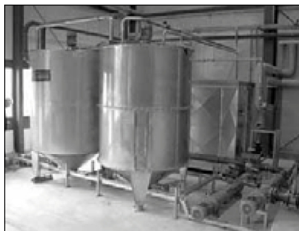
Obrázek 3–13: Hygienizace se zpětným chlazením, foto TEWE, Electronic GmbH & Co. KG
