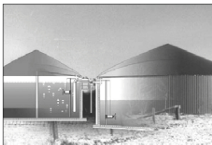
Obrázek 3–5: Plně promíchaný fermentor, průřez: Biogas Nord GmbH
