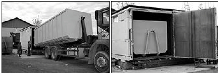
Obrázek 3–7: Zásuvný fermentor s pojízdným kontejnerem, prototypní stádium, foto: Bioferm GmbH
