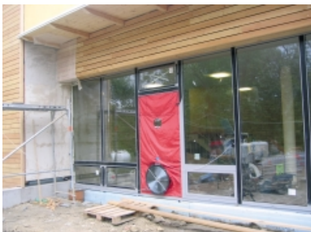
Obrázek 34: Blower-door test. Foto: Ekologický institut Veronica.
