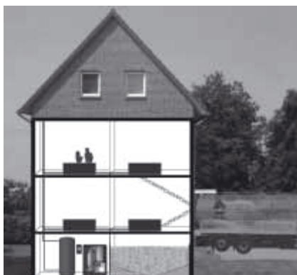
Umístění Stirlingova motoru v rodinném domě
